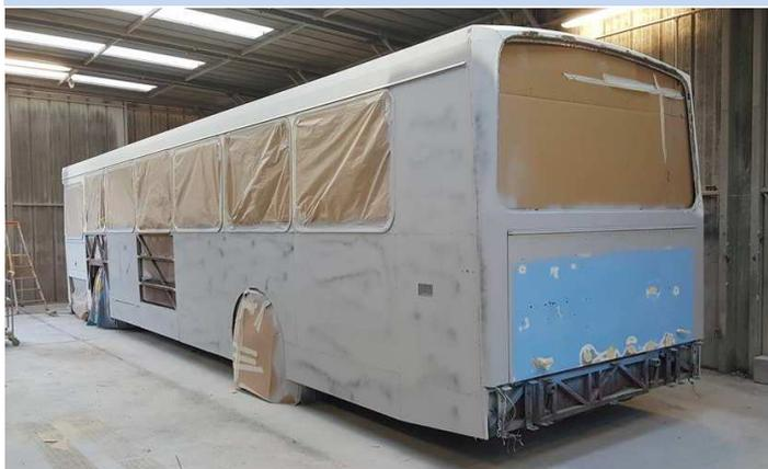
▲ Ici, le 23 novembre 2017, après le ponçage, la carrosserie est apprêtée. On remarque l'absence du pare-brise arrière, démonté avant le remplacement des tôles de contour qui étaient corrodées. © F. Rainart
